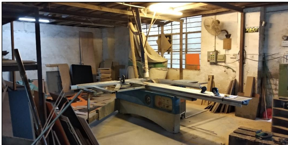
开料车间的设备及配套布袋除尘器。
